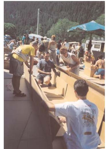
Un consiglio: visto e considerato che il nastro adesivo è "contato", usatelo soltanto per l'assemblaggio finale. Nella fase di costruzione cercate di dare forma alla canoa soltanto con un solido gioco di incastri.
